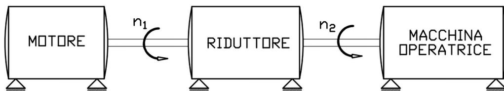
Il motore elettrico eroga una potenza di  $P = 8,5$  KW avente una velocità angolare di  $n_1 = 1500$  giri/min.
